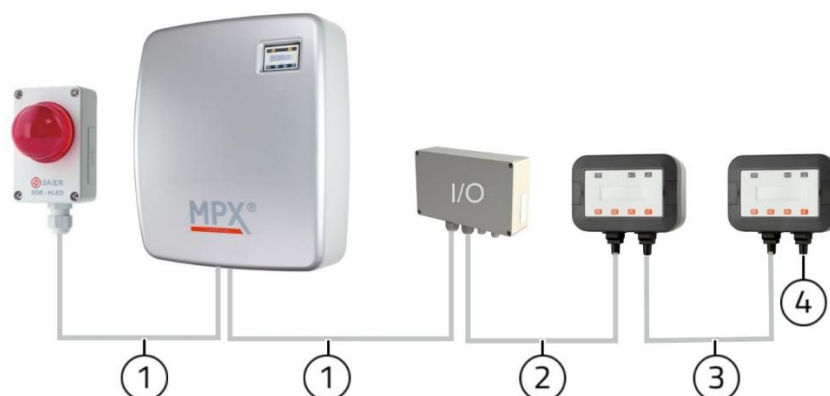
Illustration 12 : Installation du bus SD (exemple)
